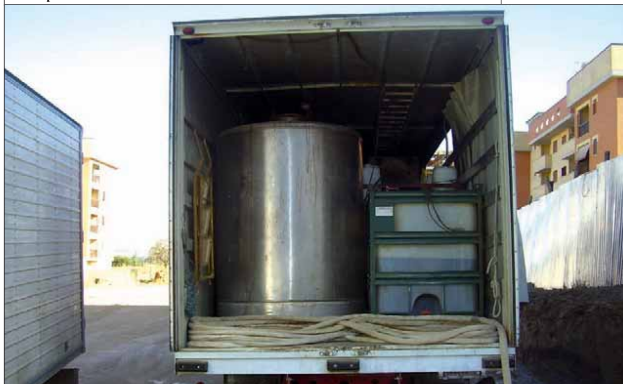
Parte posteriore dell'unità mobile con cavo contenitore delle tubazioni di servizio
