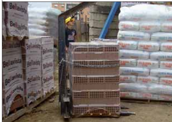
Confezione di laterizi resa solida alle forche con catena
