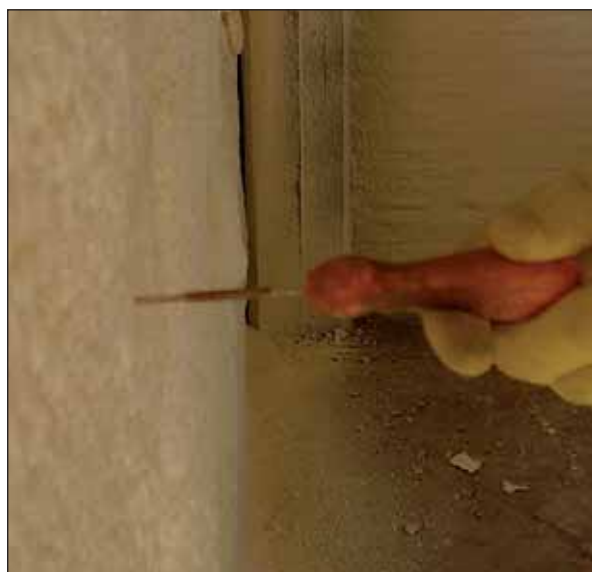
Misura dello spessore dello strato d'isolante con la punta di un punteruolo
