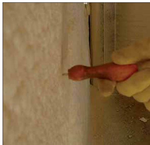
Misura dello spessore dello strato d'isolante con la punta di un punteruolo
